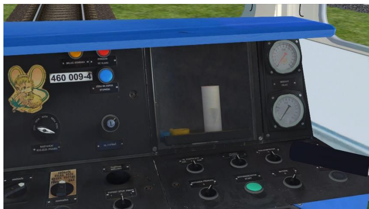
Obrázek 9 - MG běží, nyní můžeme pustit tlačítko start
