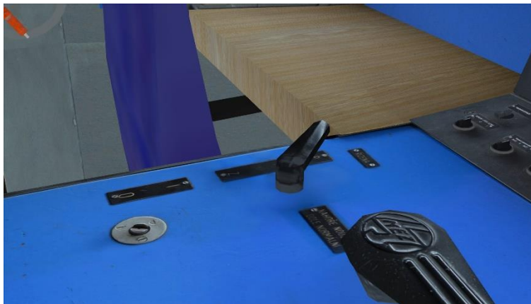
Obrázek 11 - přepnutí směrového ovladače
